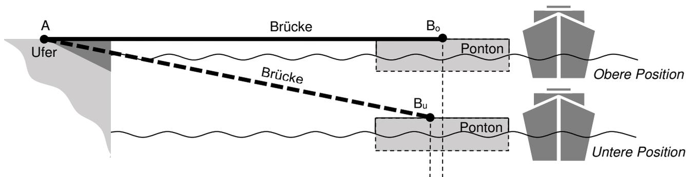
Abbildung 2 – Positionen des Pontons, seitliche Ansicht, schematische Darstellung
