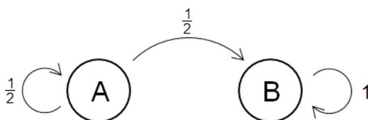
Die Entwicklung der Verteilung wird durch die Gleichung  $\vec{v}_{n+1} = M \cdot \vec{v}_n$  mit  $M = \begin{pmatrix} \frac{1}{2} & 0 \\ \frac{1}{2} & 1 \end{pmatrix}$
